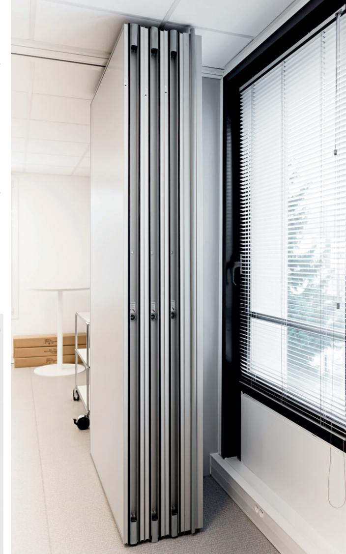
Ce mur mobile a été conçu pour s'adapter à des structures existantes, limitées par la capacité de reprise de charge. Vous avez un projet d'installation de mur mobile dans un bâtiment existant.
